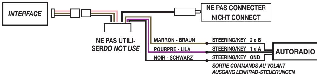
**FR - ATTENTION:** Après la programmation du dispositif, réglez les Commandes au Volant en suivant les instructions du manuel de la radio "**PROGRAMMATION COMMANDES AU VOLANT**".
